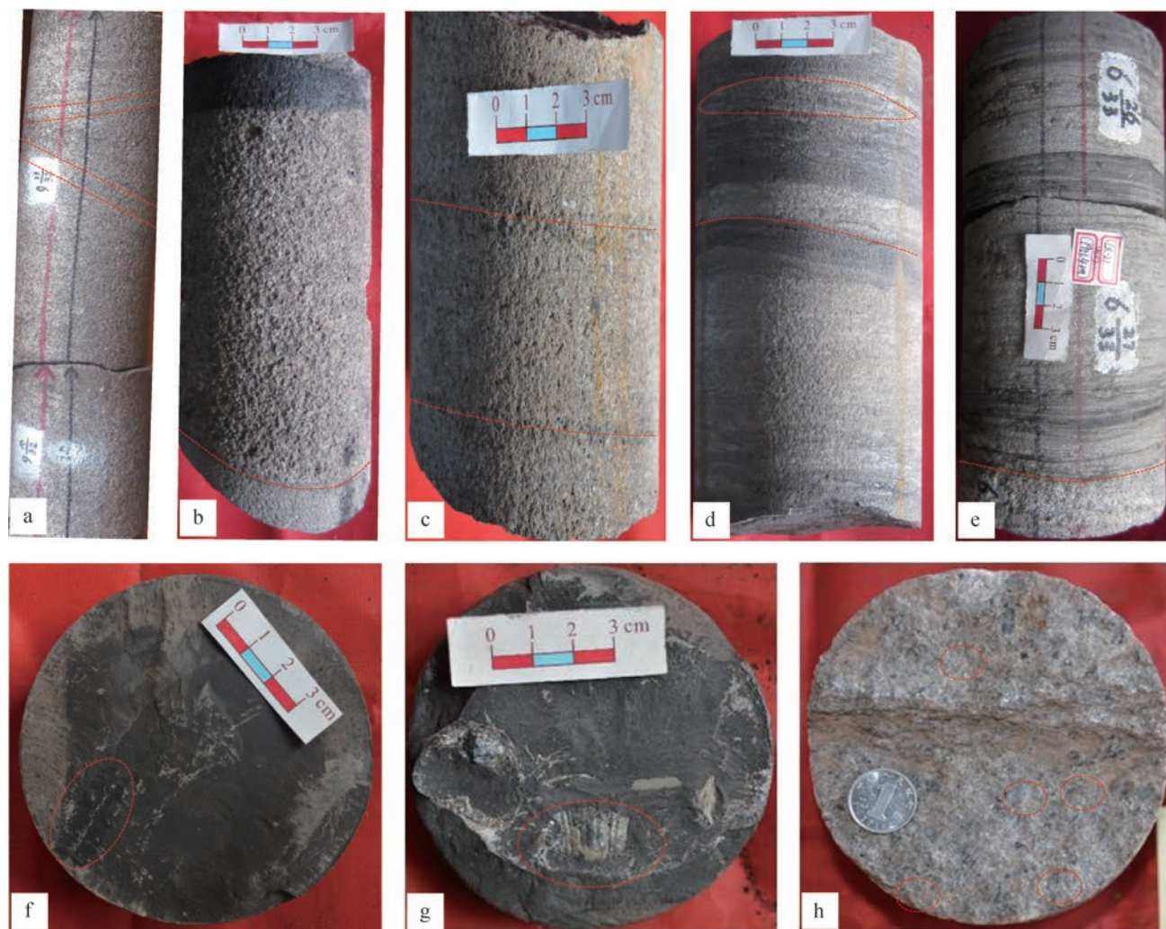
图9 鄂尔多斯盆地东缘临兴地区桥头砂岩典型沉积构造、化石及矿物特征
